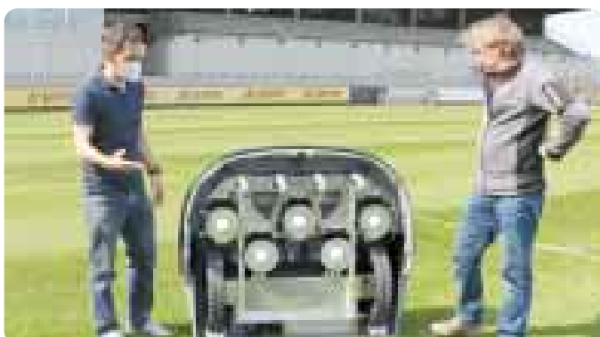
EUROGREEN-Mitarbeiter Sascha Wöhler (rechts) zeigt NFV-Mitarbeiter Michael Ernst die fünf Schneideköpfe mit je drei Messern.
