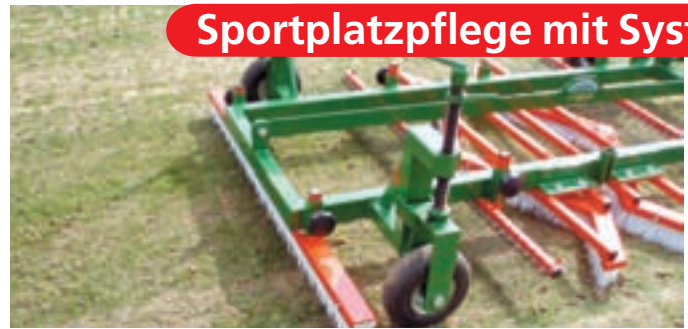
Abschleppen mildert die Auswirkung zu vieler Regenwürmer ab und verteilt den Sand in der Rasennarbe.
